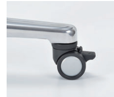
アジャスト機能付きキャスター キャスター上部のリングにより高さが調節できます。制動力の高いリフトロック式ストッパーです。
